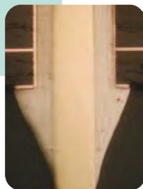
Teplovní cyklování 200 cyklů od -25 do +125 °C, s prodlevou 20 minut, celková doba cyklu 55 minut
