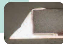
Teplovní cyklování 200 cyklů od -25 do +125 °C, s prodlevou 20 minut, celková doba cyklu 55 minut
