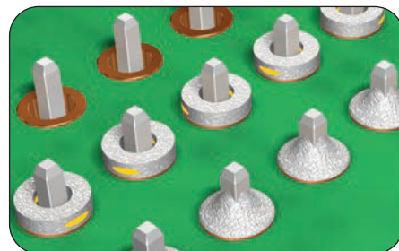
Holé vývody, podložky na místě před přetavením, po přetavení
